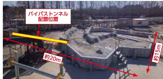
写真2 ダム下流の河道を再現した全体模型
