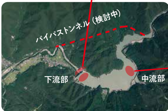
ボーリング (土砂採取) 地点
